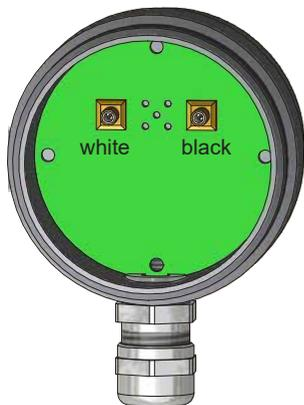
Les sondes avec raccordement au processus disposent de embases de connexion (Y70) dans la tête. Pour le raccordement, il faut desserrer le couvercle, introduire le connecteur par le presse-étoupe et le relier aux douilles correspondantes. Ici, les prises sont identifiées par le code couleur correspondant à module de contrôlé.
