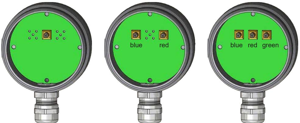
Le sonde con collegamento al processo sono dotate di connettori (Y70) nella testa. Per il collegamento, allentare il coperchio, inserire il collegamento a spina attraverso il pressacavo e collegarlo alle prese appropriate. I punti di commutazione sono contrassegnati dal codice colore superiore.
