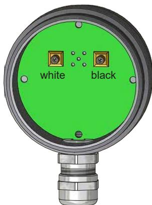
Sonden mit Prozessanschluss verfügen über Buchsen (Y70) im Kopf. Zum Anschluss ist der Deckel zu Lösen, die Steckverbindung ist über die Kabelverschraubung einzuführen und mit den passenden Buchsen zu verbinden. Hier sind die Buchsen mit der Farbcodierung entsprechend zum Auswerter gekennzeichnet.
