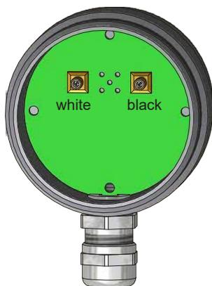
Le sonde con collegamento al processo sono dotate di connettori (Y70) nella testa. Per il collegamento, allentare il coperchio, inserire il collegamento a spina attraverso il pressacavo e collegarlo alle prese appropriate. Qui le prese sono contrassegnate con il codice colore corrispondente all'unità di valutazione.
