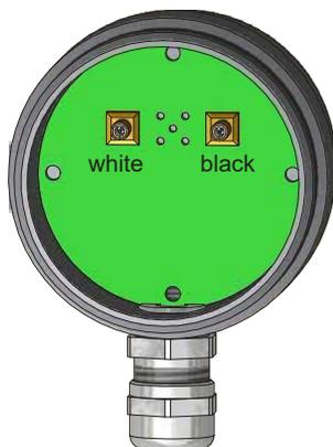
Las sondas con conexión a proceso tienen tomas (Y70) en la cabeza. Para realizar la conexión, afloje la tapa, introduzca la clavija de conexión a través del prensaestopas y conéctela a las tomas correspondientes. Aquí las tomas están marcadas con el código de colores correspondiente al evaluador.
