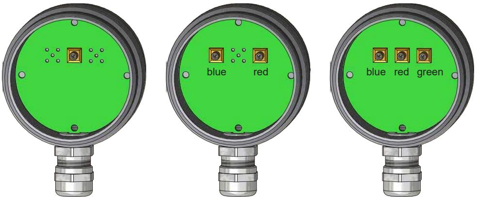
Las sondas con conexión a proceso tienen tomas (Y70) en la cabeza. Para realizar la conexión, afloje la tapa, introduzca la clavija de conexión a través del prensaestopas y conéctela a las tomas correspondientes. Aquí, los puntos de conmutación se marcan mediante el código de color superior. Encontrará las conexiones de enchufe adecuadas en nuestro programa de accesorios.
