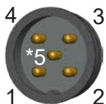
4 3 Pinbelegung steckbarer Sonde (Draufsicht)
