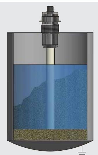
Le principe de mesure breveté à trois électrodes inclut le récipient dans la mesure. Le récipient doit donc être en métal ou une électrode supplémentaire, par exemple une feuille ou une tige métallique, couvrant au moins la zone de mesure, doit être fixée au récipient. (longueur de la feuille  $\geq$  longueur de la sonde). Le grand volume de mesure qui en résulte est la raison pour laquelle les dépôts à la surface de la sonde ne sont pratiquement pas pertinents pour la mesure.
