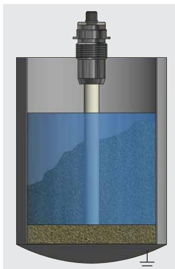
El principio de medición patentado de 3 electrodos incluye el recipiente en la medición. Por lo tanto, el recipiente debe ser metálico o se debe fijar al recipiente un electrodo adicional, por ejemplo, una lámina metálica o una varilla metálica, que cubra como mínimo el área de medición. (Longitud de la lámina  $\geq$  longitud de la sonda). El gran volumen de medición resultante es la razón por la que los depósitos en la superficie de la sonda son prácticamente irrelevantes para la medición.
