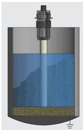
Das patentierte 3-Elektrodenmessprinzip bezieht den Behälter in die Messung mit ein. Der Behälter muss deshalb aus Metall sein oder eine Zusatzelektrode z. B. Metallfolie oder Metallstab, die zumindest den Messbereich überdeckt, ist an dem Behälter anzubringen. (Länge der Folie  $\geq$  Sondenlänge). Das dadurch entstehende große Messvolumen ist der Grund dafür, dass Ablagerungen auf der Sondenoberfläche für die Messung praktisch irrelevant sind.
