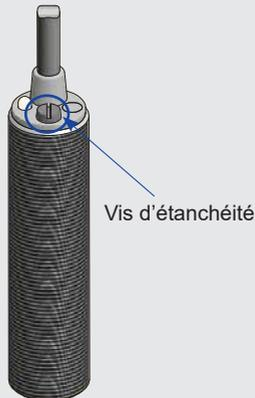
Pour effectuer les réglages du potentiomètre, retirez d'abord la vis d'étanchéité.
