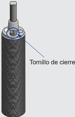
Para realizar ajustes en el potenciómetro, retire primero el tornillo de cierre.
