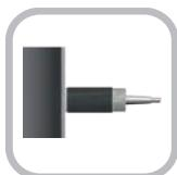
**Für bündigen Einbau in Metall und andere Materialien.** Diese können auch dicht an dicht angeordnet werden und sind besonders geeignet zur berührungslosen Abtastung von Festkörpern oder Flüssigkeiten, durch nichtmetallische Trennwände oder durch einen Bypass (max. Wandstärke 4 mm).
