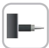
Para el montaje enrasado en metales y otros materiales, pueden ser instalados incluso muy juntos y son especialmente adecuados para la detección de cuerpos sólidos a distancia sin contacto o la detección de cuerpos sólidos o líquidos a través de paredes separadoras de material no metálico (espesor máx. de pared = 4 mm)
