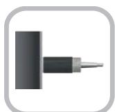
**Per montaggio a filo su metallo e altri materiali.** Questi sensori possono essere montati vicini e sono particolarmente adatti a rilevamenti senza contatto di solidi o liquidi attraverso contenitori non metallici (max. spessore contenitore 4 mm)
