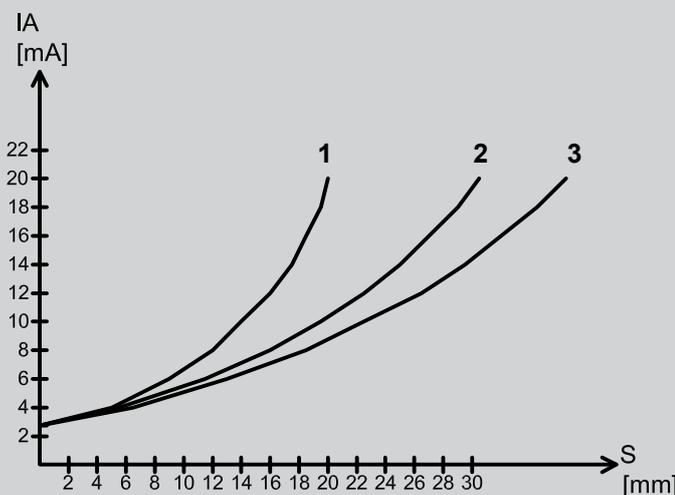
Capteur analogique à 3 fils, avec divers réglages
