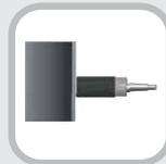
Outre le contrôle de niveau avec contact avec le produit à détecter, il est possible, en alternative, de détecter le produit à travers une paroi de réservoir non métallique. Il est à noter, qu'à l'endroit où se fait la mesure, l'épaisseur de la paroi doit être de 4 mm max.
