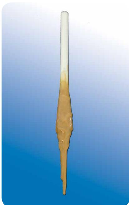
*Même un dépôt de quelques cm de colle, sur la sonde, ne nuit pas à la mesure. Décalage du seuil de commutation : max  $\pm$  0.5cm.*
