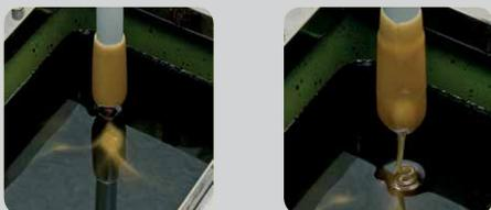
La sonde commute également, avec une grande fiabilité, lorsqu'un filet de colle relie encore le produit résiduel, au fond du réservoir, à la sonde.
