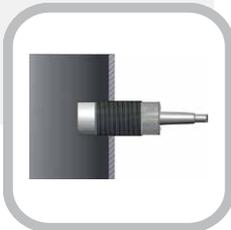
Con el control de nivel de líquidos y sólidos, en la mayoría de los casos, la medición del nivel es hecho de modo que la superficie activa del sensor entra en contacto directo con el producto que se desea a detectar. Dependiendo del producto que desea detectar, existen requisitos específicos para el diseño de la carcasa del sensor, en particular con respecto a los partes del sensor que entran en contacto directo con el producto.
