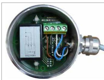
1. Raccordez le câble de raccordement (24V, GND, Output) à la borne de la tête de raccordement.
