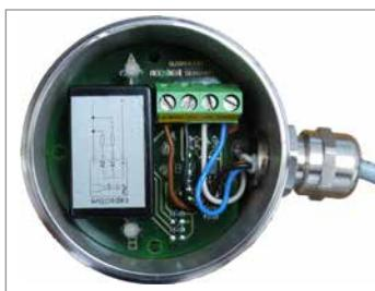
1. Collegare il cavo di collegamento (24V, GND, Output) al terminale della testa di connessione.
