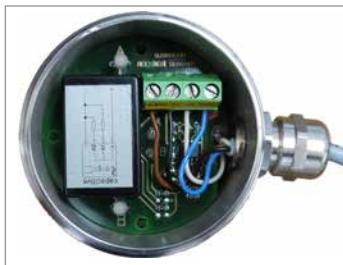
1. Schließen Sie die Anschlussleitung (24V, GND, Output) an der Klemme im Anschlusskopf an.
