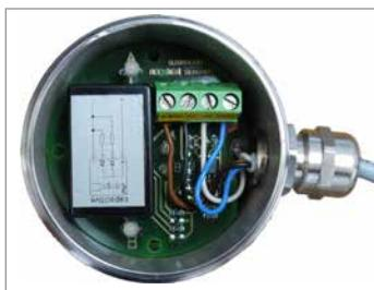
1. Conecte el cable de conexión (24V, GND, Salida) al terminal del cabezal de conexión.
