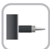
**Montage encastrable dans le métal ou autres matières.** Ces modèles peuvent également être montés côte à côté et ils sont particulièrement adaptés à la détection de corps solides ou de niveaux de liquides au travers de parois non métalliques (épaisseur maximale: 2 mm).
