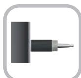
Para el **montaje enrasado** en metales y otros materiales, pueden ser instalados incluso muy juntos y son especialmente adecuados para la detección de cuerpos sólidos a distancia sin contacto o la detección de cuerpos sólidos o líquidos a través de paredes separadoras de material no metálico (espesor máx. de pared = 2 mm)
