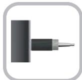
**Per montaggio a filo su metallo e altri materiali.** Questi sensori possono essere montati vicini e sono particolarmente adatti a rilevamenti senza contatto di solidi o liquidi attraverso contenitori non metallici (max. spessore contenitore 2 mm)
