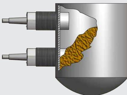
Détection de tous produits dans un réservoir ou au travers d'une fenêtre non métalliques (capteurs encastrables).
