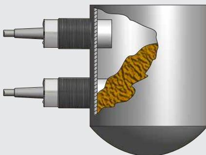
Rilevamento di tutti i materiali tramite contenitore non metallico o finestra di controllo (montaggio a filo).
